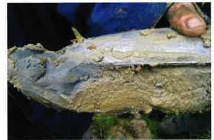
Figuur 4. Boring 6 op 90 cm diepte: geelwit schelpengruislaagje (nat kalkrijk zand van Alden Biesen) op blauwe klei (Klei van Henis).
