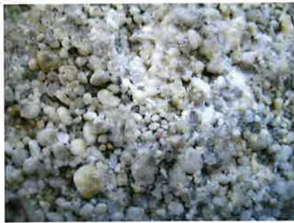
Figuur 28. Detailfoto van een grofkorrelige variant van de holsetzandsteen, lokale bouwsteen in de Voerstreek en Nederlands Limburg. De grootste korrel meet ongeveer 0,5 cm. (Foto Roland Dreesen)
